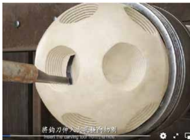
圖十八 以鉤刀由內往外橫向切割分層。（圖片截圖自〈透視象牙球完整影片〉）
