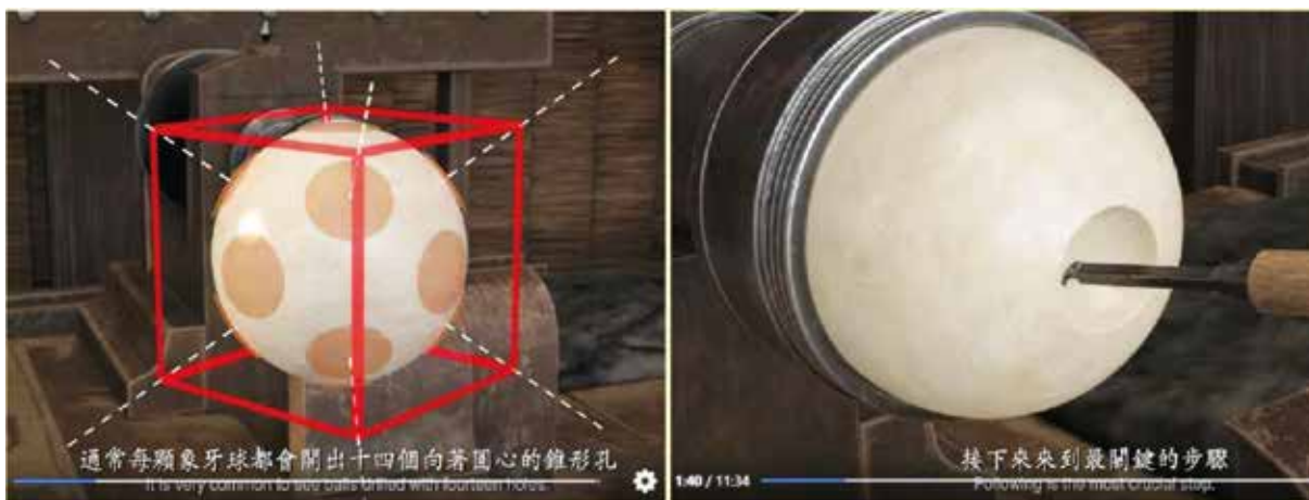
圖十七 往圓心處鑿出均勻分布的十四個錐形孔。(圖片截圖自〈透視象牙球完整影片〉，經作者後製組合)
